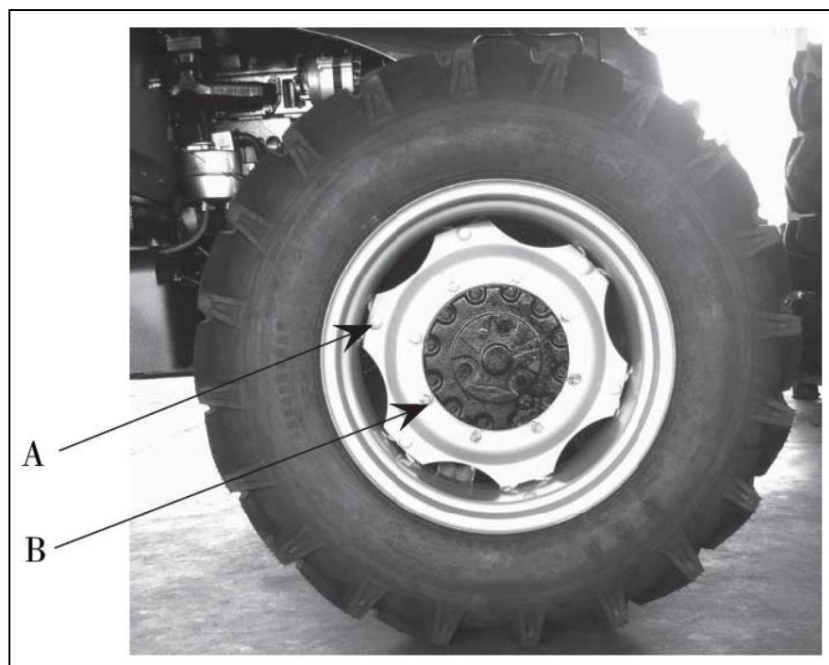
A- perno que conecta la llanta con el disco radial; b- perno que conecta el disco radial con la brida del eje
