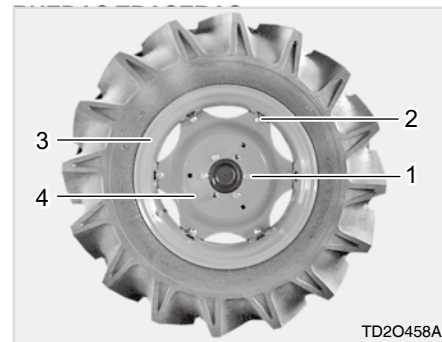
(1) Perno de la rueda (2) Perno de la llanta (3) Llanta (4) Plato
