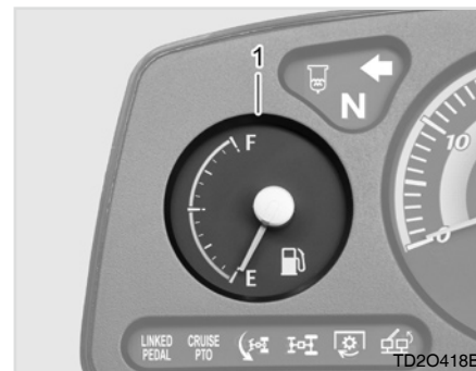
(1) Medidor de combustible
