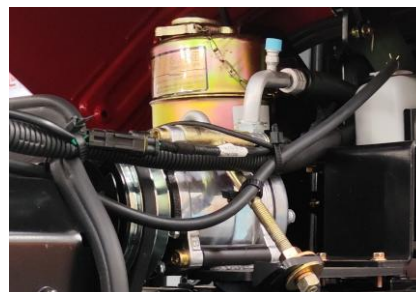
Figura 8 -23 Mantenimiento de depósito de aceite de dirección hidráulica (cambiar la figura)
