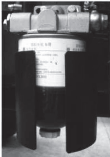
Fig. 5-13 Copa de sedimentos de combustible
