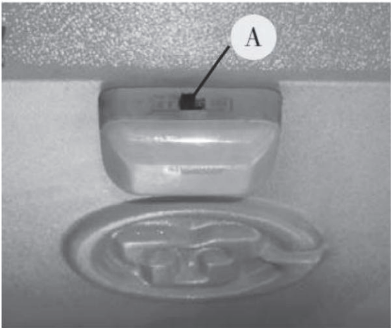
Figura 4-24 Lámpara de techo y su interruptor
