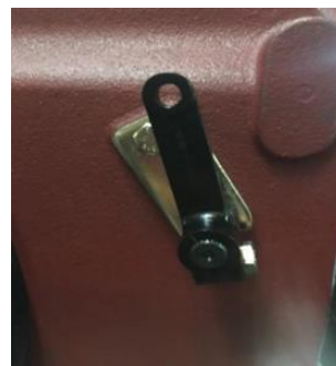
Figura 5-34 Cambio de toma de fuerza (PTO) de tractor
