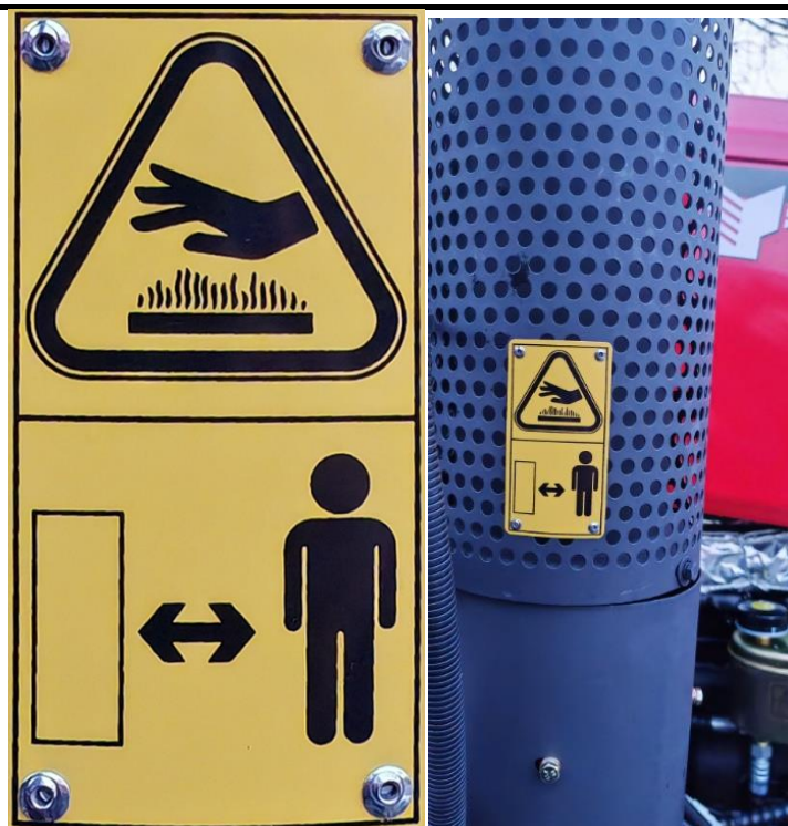
Malla protectora de aislamiento térmico de silenciador, superior
