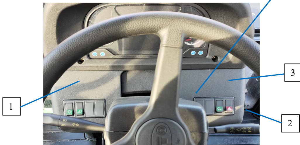
Figura 4-4 Posición de interruptor de control sobre salpicadura
