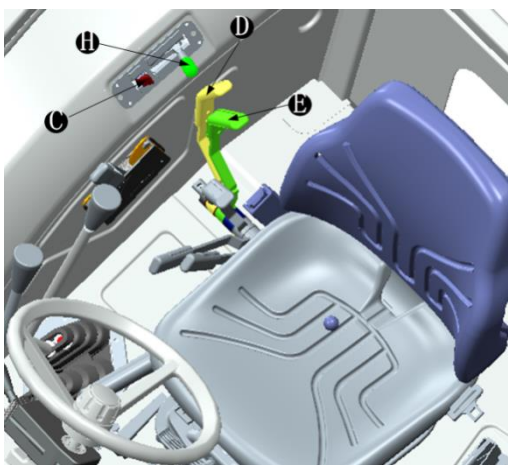
Figura 4 -28 Palanca de control de posición y fuerza
