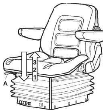
Figura 4 -21 Ajuste de asiento de cabina
