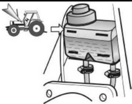
Figura 5 -2 Inspección de nivel de depósito de aceite de freno de servicio
