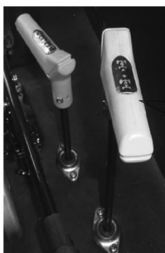
Figura 4 -10 Palanca de articulación de accionamiento de puente delantero
